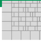
Posa a correre
