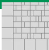
Posa a correre
