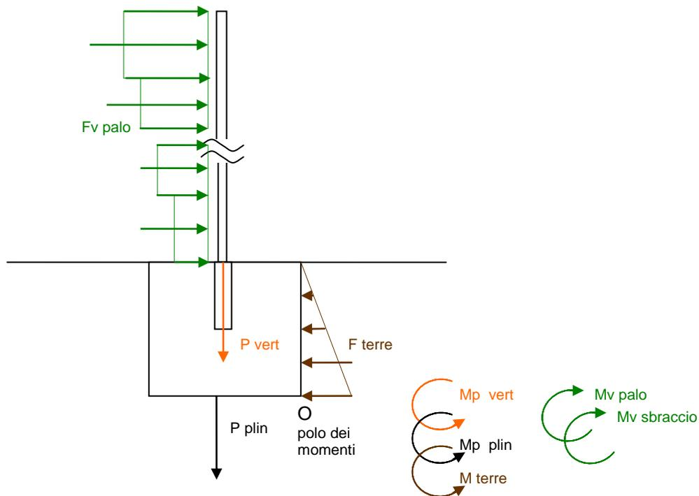
**Figura 5: Configurazione di carico A, forze agenti.**
