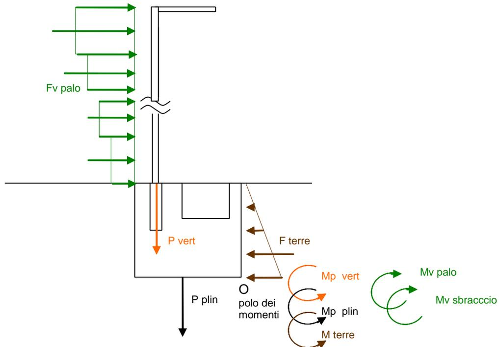
**Figura 6: Configurazione di carico B, forze agenti.**
