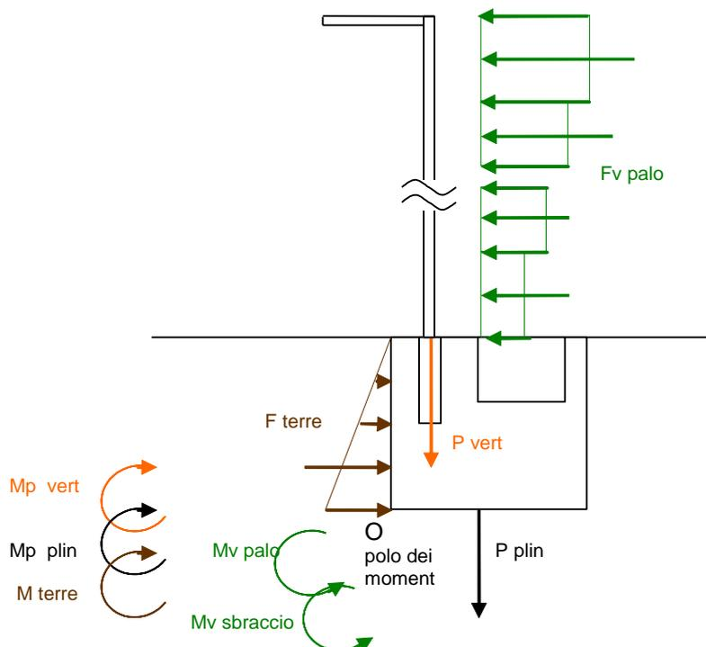
**Figura 7: Configurazione di carico C, forze agenti.**
