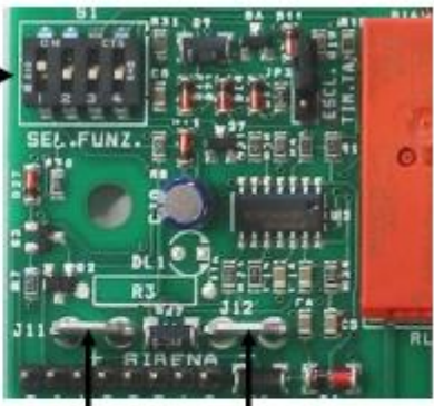
USCITA 12Vcc PER SIRENA attiva solo con intervento del galleggiante di massimo livello (ALLARME G.A.)
