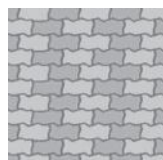
Posa a correre
