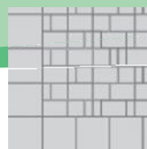
Posa a correre
