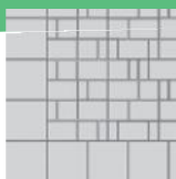
Posa a correre
